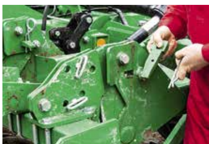
A henger leszereléséhez hat ponton kell a záró reteszt eltávolítani. Ugyanezen a helyen a csapszegek rögzítik a henger dőlését.
