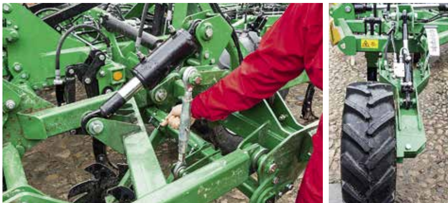
A munkamélység hidraulikusan kényelmesen állítható. A mélységvezetéshez az X4 elől kissé kicsi kerekre támaszkodik, hátul pedig a fogas tömörítő hengerre, illetve a futóműre.
