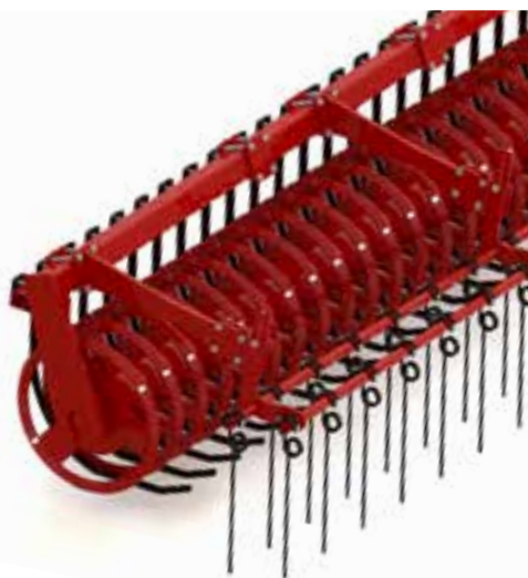
Gyűrűs tömörítő henger Ø 470 mm 2 soros utánfutó fésűboronával Ø 10 mm rugós fogakkal, csak a VIBROSTAR 5....-höz kapható!
