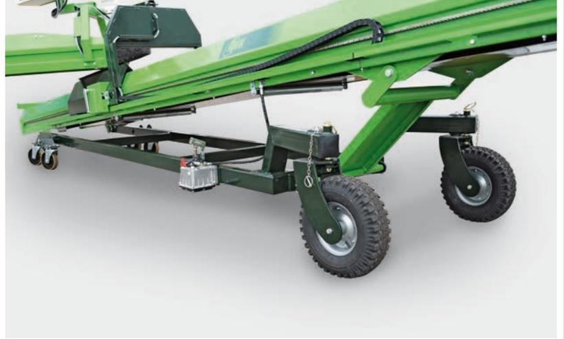
Stabiler Rahmen mit hydraulischer Höhenverstellung
