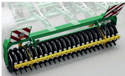
CW zárt ékgyűrűs (CRACKER) henger
