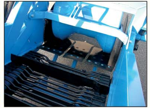
Rullo pressore e triplo vomere in acciaio speciale Bakhtát henger és speciális háromrészes acél ásókés
