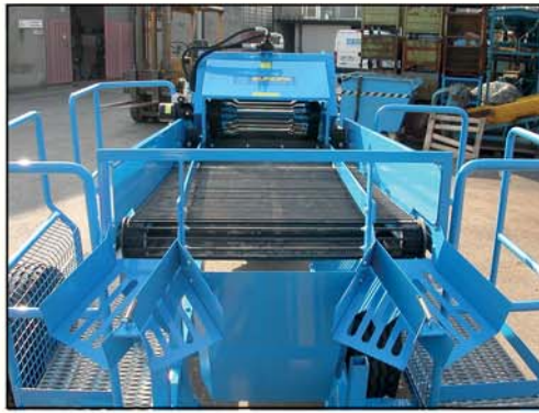
33,5 inches conveyor belt for product selection 850 mm-es pálcás szállítószalag a termék kiválogatásához
