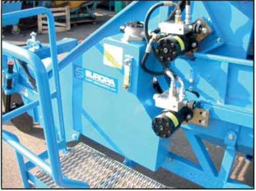
Hydraulic motors, flux regulators and 60 litre oil tank Hidromotorok fordulatszám-szabályzóval és 60 literes olajtartály
