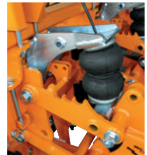
ELŐ-TERHELŐ RENDSZER PNEUMATIKUS GUMIHARANGGAL OPCIONÁLIS
