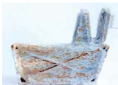
Tűzhorganyzott mintadarab: 100% fehérrozsdá képződés
