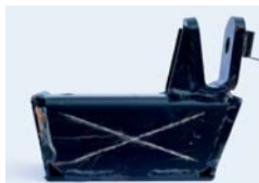
Brantner ACC 86 mintadarab: minimális rozsdaterjedés > 3,5 mm
