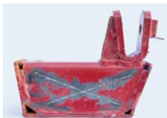
Alapozott + 2K lakkozott mintadarab: látható rozsdaterjedés < 3,5 mm
