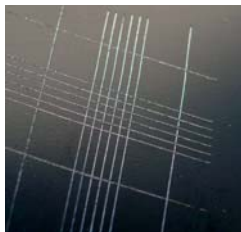
Tűzhorganyzott mintadarab: 100% fehérrozsdá képződés
