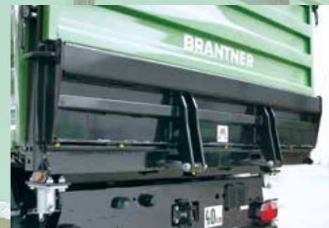
Hidraulikus hátsó fal nyitás 120° préselt profilból
