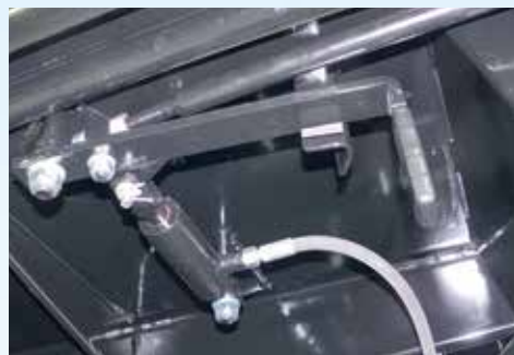
Hidraulikus lengő oldalfal reteszelés hátsó
