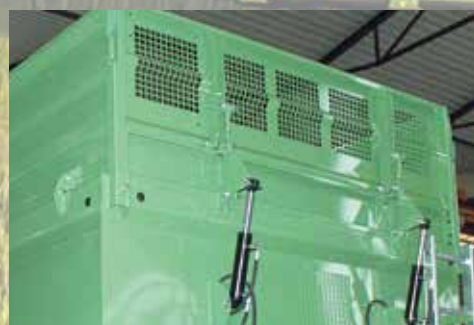
Homlokfal hidraulikusan lebillenthető
