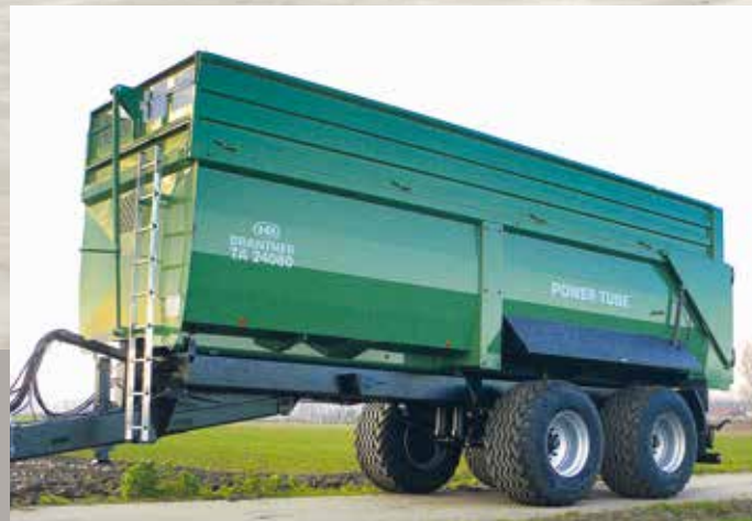
TA 24080/2 Power Tube teknő hossza 8.000 mm (kormányzott tengely a nyomtáv 2.250 mm alapkivitelen)
