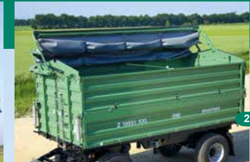
Cabrio ponyva hidraulikus kezeléssel
