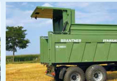
Hidraulikus hátsó fal nyitás kettős működésű
