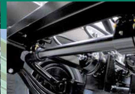
Rugó stabilizátor az optimális futásjellemzőkhöz
