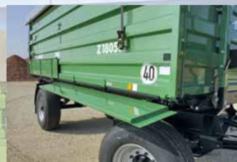
Stabil csúszda oldalt lengőfallal együtt reteszeltető
