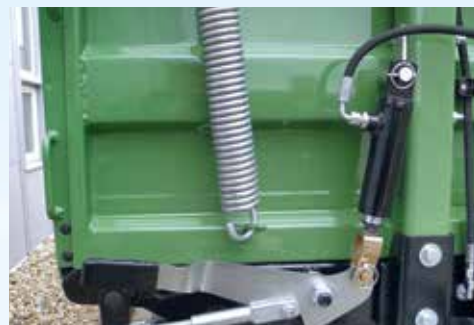
Hidraulikus lengő oldalfal reteszelés balra és jobbra átdugható
