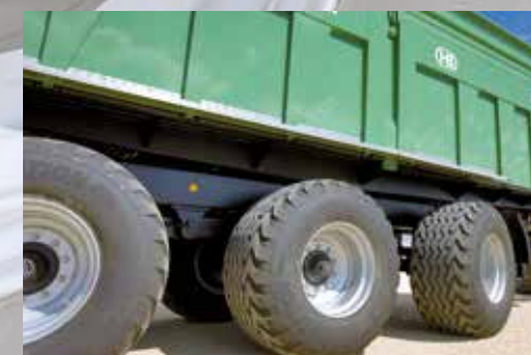
Kormányzott utánfutó tengely növeli a fordulékonyt és csökkenti a gumikopást
