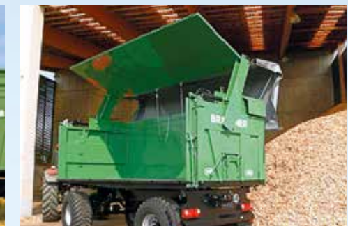
Hidraulikus Stabilator oldalfal felfelé nyíló
