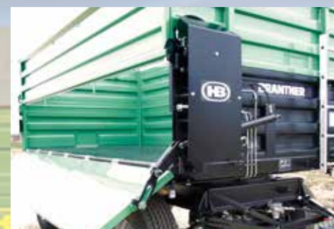
Hidraulikus oldalfal nyitás oldalra 180°, nyitás és zárás
