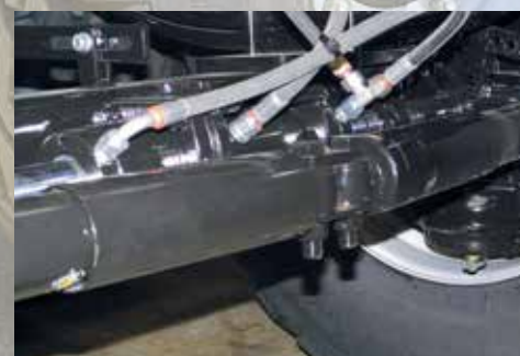
Utánfutó kormánytengely reteszelni kell hátrahúzásnál és közúti közlekedésnél
