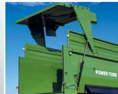
Hidraulikus kettősműködésű hátsóoldal nyitás
