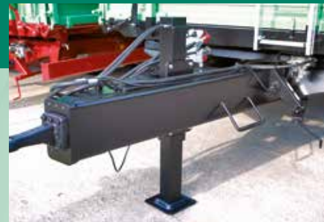
Hidraulikus támasztóláb kettősműködésű, cső-a-csőben vezetés
