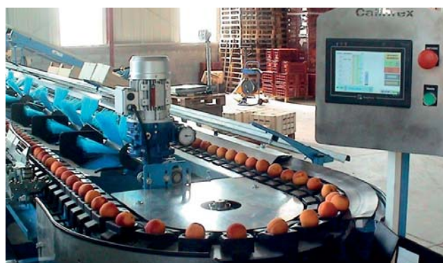
Ellipszis kialakítású, helytakarékos osztályozó pálya
