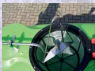
Dobozmosó fent a töltőszűrőben: öblíteni és tisztítani a vegyszeres göngyöleget, dobozt.
