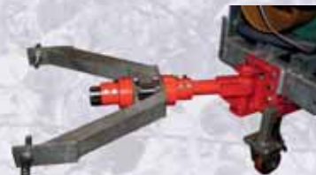
Nyomkövető vonórúd: A vonórúd forgáspontjának előretolásával a traktor és a permetezőgép között jobban követi a raktornyomot, és kisebb a fordulási sugár is.
