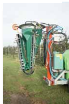
Hidraulikusan összecsatolható légszák
