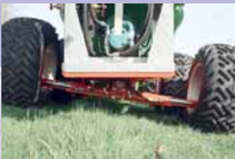
Hidraulikus színtezés és nyomtávállítás: Az egytengelyes gép színtezéséhez szélességben lejtős talajon.
