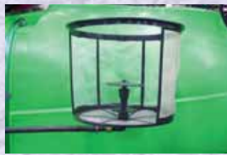
Vegyszerbemosó a töltőszűrőben: bemosni a növényvédő szert a tartályba.
