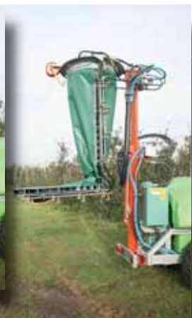
Hidraulikusan összecsatolható légszák
