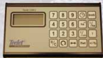
Permetezőmonitor LH 1200 S Az alábbi kijelzések jeleníthetők meg: Idő felhasználás, menetsebesség, Hektár terület mérés, adagolás liter /hektár, aktuális adagolás liter l/perc, permetezett liter mennyiség
