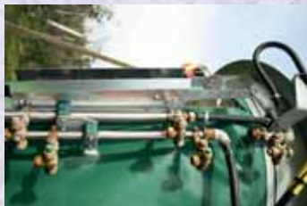
Dupla permetező vezetékek: kiegészítő permetévezeték rendszer elsodródás mentes fűvókával és elektromos szelepekkel.
