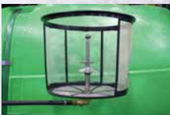
Kombinált dobozmosó / vegyszerbemosó: bemosni a növényvédő szert a tartályba, és öblíteni és tisztítani a vegyszeres göngyöleget, dobozt.
