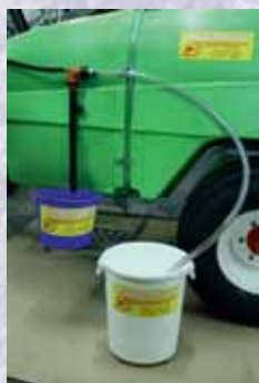
Venturi-töltő: a vegyszer felszívásához és a tartályba töltéséhez, mind folyékony, mind granulátum esetében
