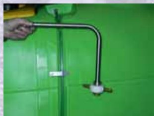
Tartálytisztító: a tartály belső felületét tisztítja, mindamelllett csekély veszéllyel, hogy a vegyszermaradványt még kezelní kell.
