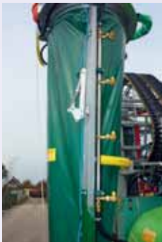
Elzárható légzsák egy oldalon: Ezzel az opcióval teljesítjük a beültetetlen művelési sávban az elsodródás csökkentését 95%-ra.
