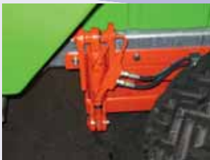
Hidraulikus színtezés egytengelyes gépnél: Az egytengelyes gép színtezéséhez szélességben lejtős talajon.
